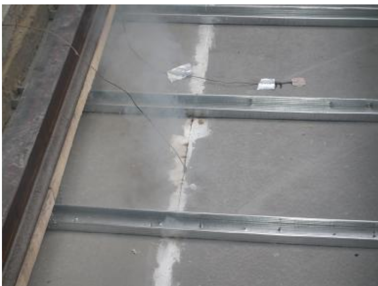
29. minúta skúšky – mierne dymenie zo spojov dosák
